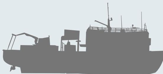
e a avaliação de sistemas de propagação da energia acústica, também serão atribuições dos pesquisadores que estiverem embarcados. O AvPq “Aspirante Moura” incorpora, em sua estrutura, uma inovação na Marinha do Brasil, pois é o primeiro a navegar sem o uso de leme, substituído por hélices azimutais, que giram 360°, integradas a um sistema de piloto automático e cartas náuticas eletrônicas, garantindo uma melhor governabilidade.
