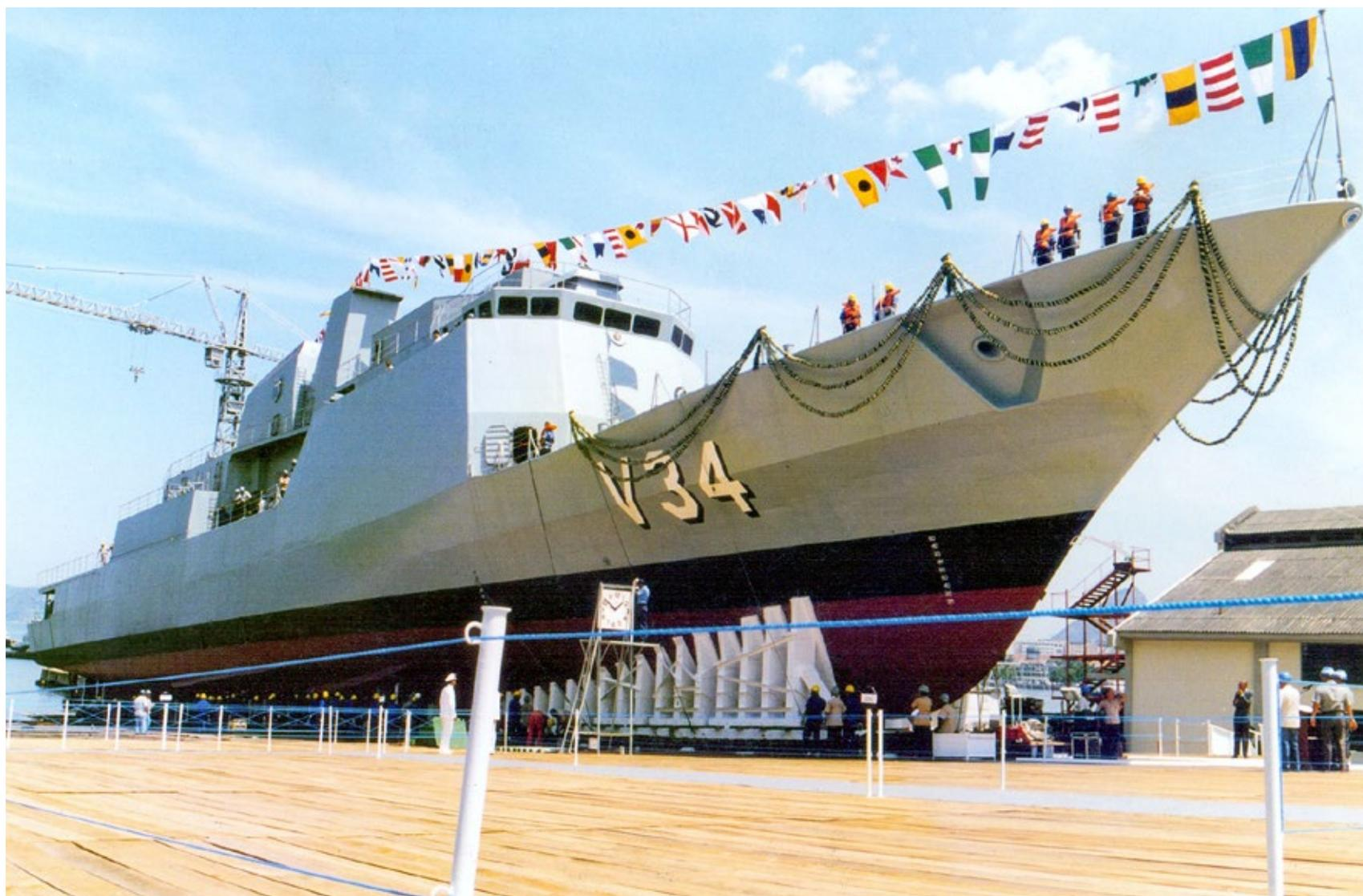
A partir da avaliação operacional e de engenharia da Corveta “Classe Inhaúma”, foi elaborado o projeto da Corveta “Barroso”, um pouco maior que as corvetas “Inhaúma”, com 104 m de comprimento e deslocamento de 2350 t. A Corveta “Barroso” também foi contruída no Arsenal de Marinha e incorporada à Armada Brasileira em 2008. Seu nome é homenagem ao Almirante Francisco Manuel Barroso da Silva, herói de Riachuelo.
