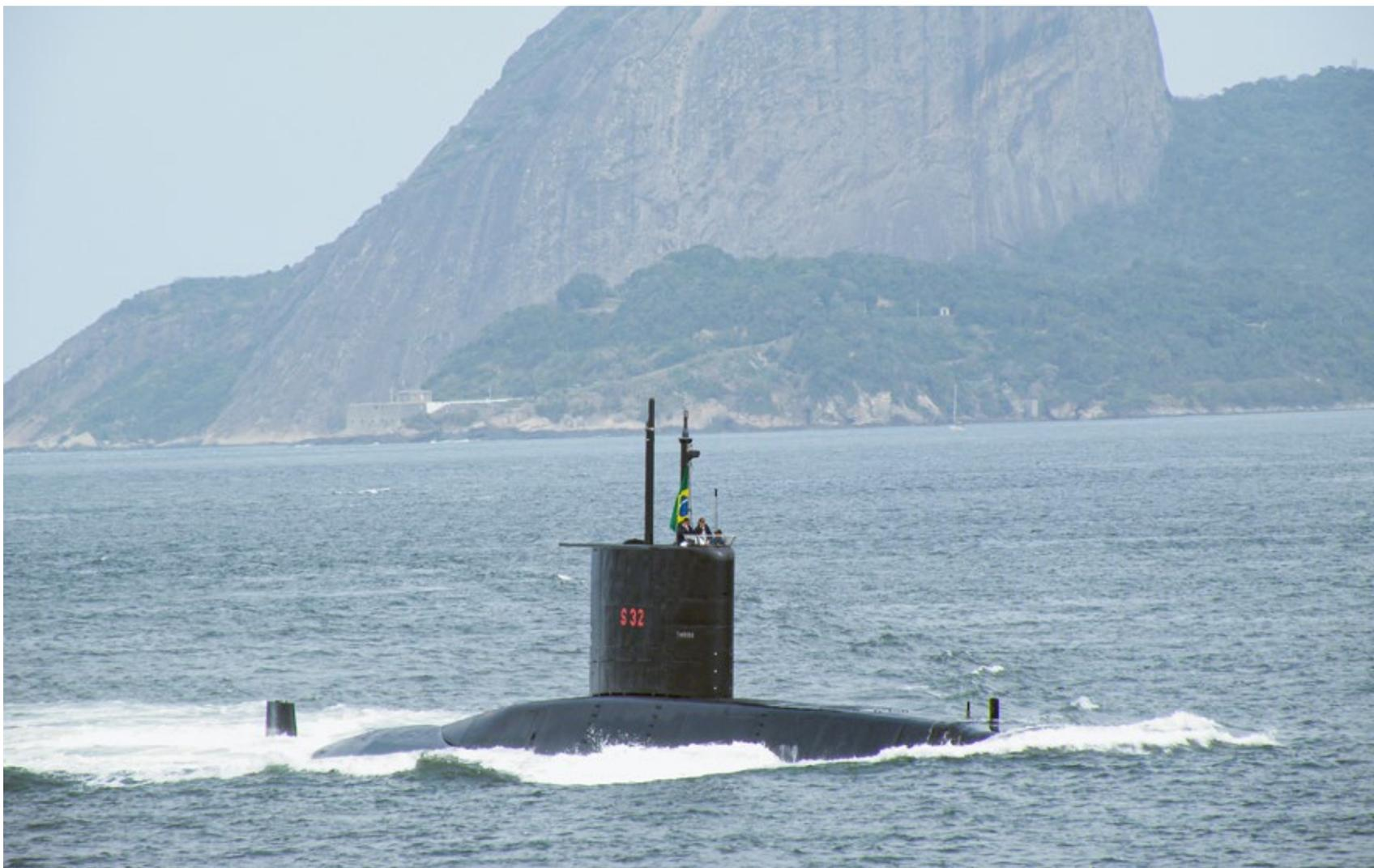
Em 1984, foi iniciada a construção de quatro submarinos Classe “Tupi”, com tecnologia alemã. São submarinos convencionais com propulsão diesel-elétrica, com 61 m de comprimento e deslocamento, na superfície, de 1.400 t. O primeiro da classe, o S30 “Tupi”, foi construído no estaleiro HDW, na Alemanha, e os três demais no AMRJ.
