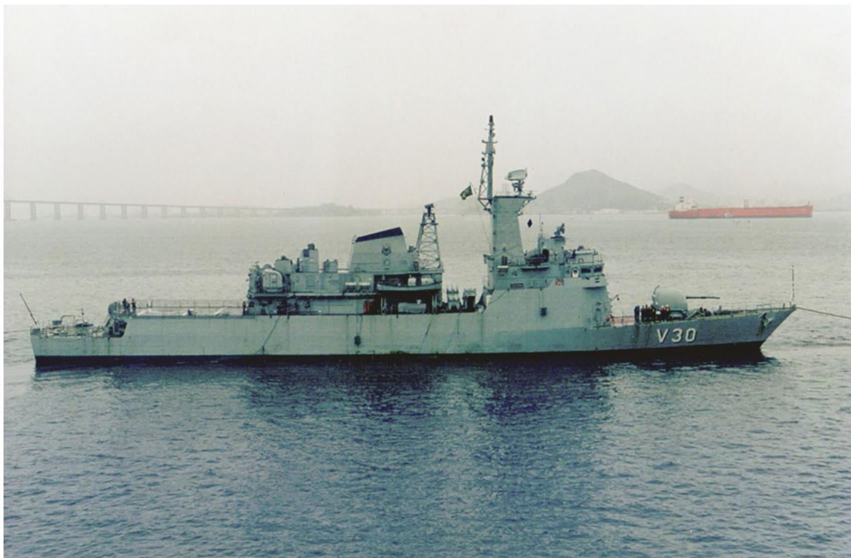
Foi iniciada em 1982 a construção das quatro corvetas da Classe “Inhaúma”. São navios de 1.900 t de deslocamento e 96 m de comprimento. Essas corvetas, com projeto
