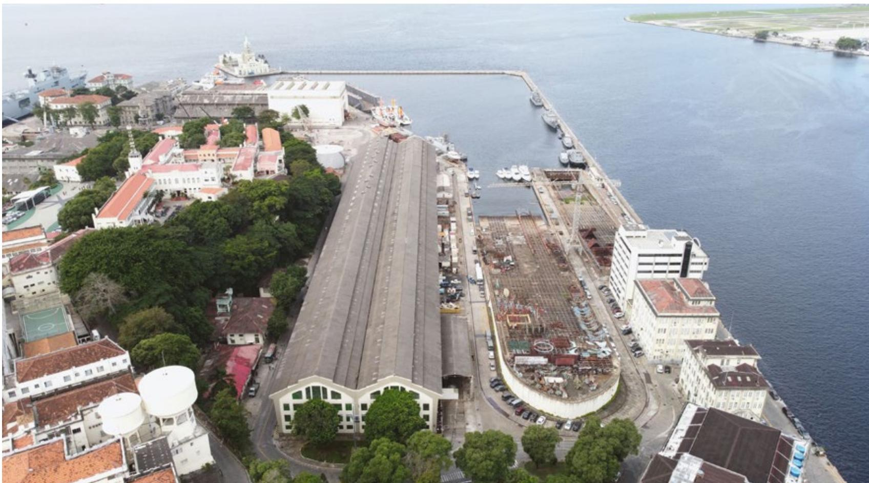
O Arsenal dispõe, ainda, de duas carreiras, sendo uma de 224 metros de comprimento por 40 de largura, onde são executadas as obras de construção naval; e outra menor, de 116 metros de comprimento por 25 metros de largura,
