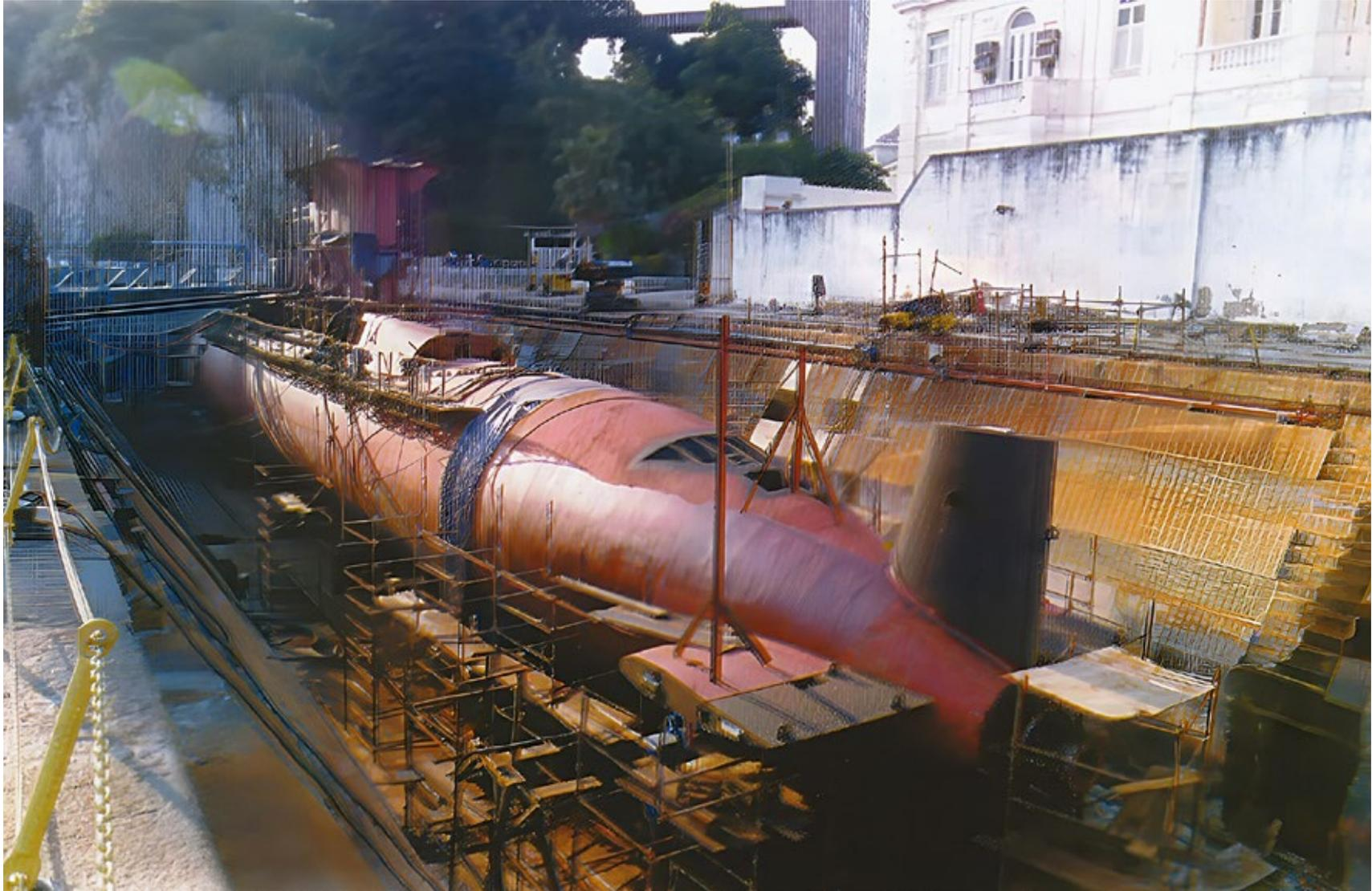
O processo de soldagem do casco de um submarino exige técnicas muito detalhadas, processo este que foi assimilado pelos técnicos do AMRJ, permitindo a conclusão de três submarinos no prazo previsto. Em 1996, foi iniciado o primeiro Programa Geral de Manutenção (PMG) do
