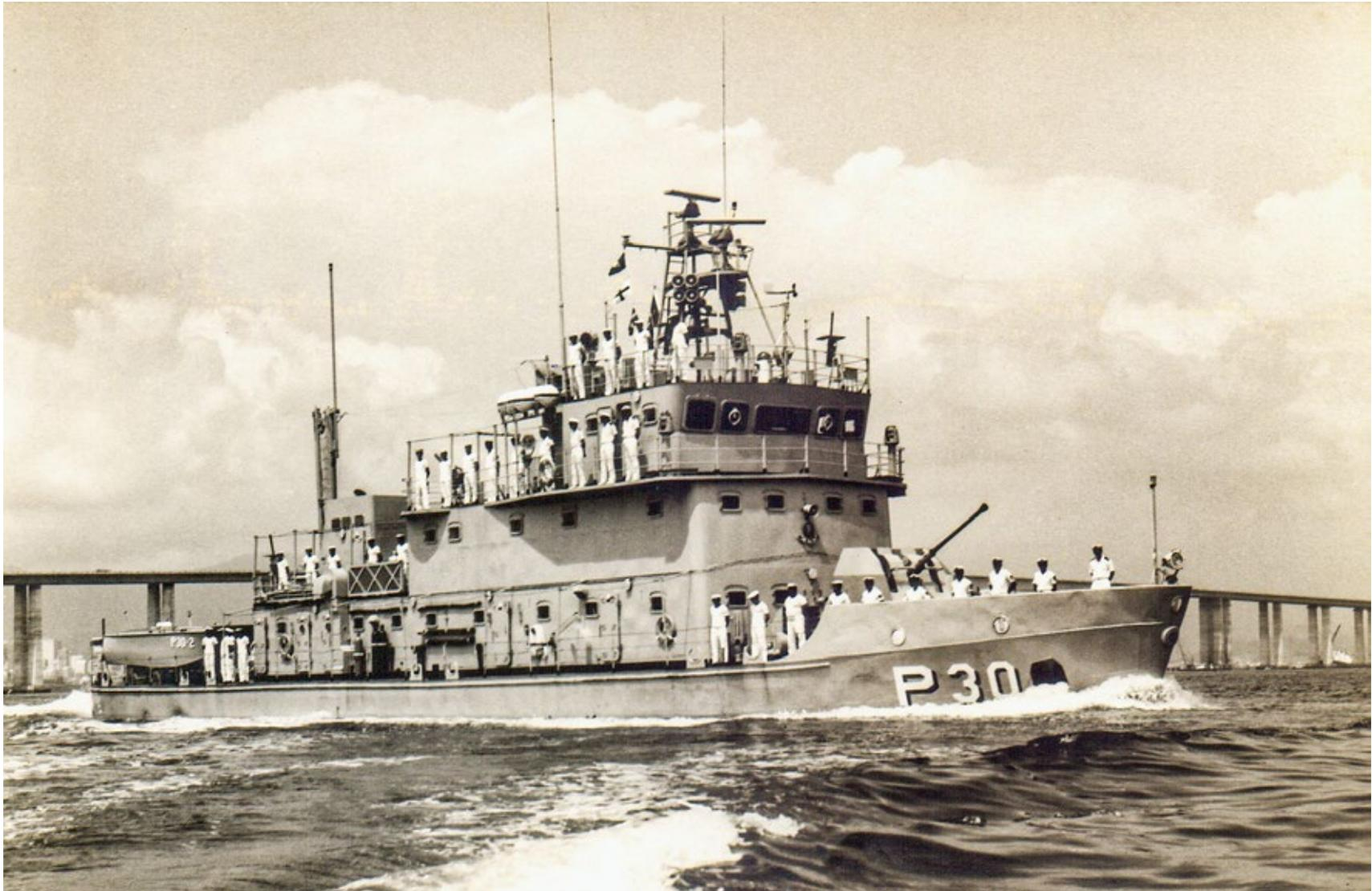
Com dois motores Diesel, os navios “Classe Roraima” alcançavam um Raio de Ação de 6000 milhas, navegando a 11 nós de velocidade e com autonomia de 30 dias.
