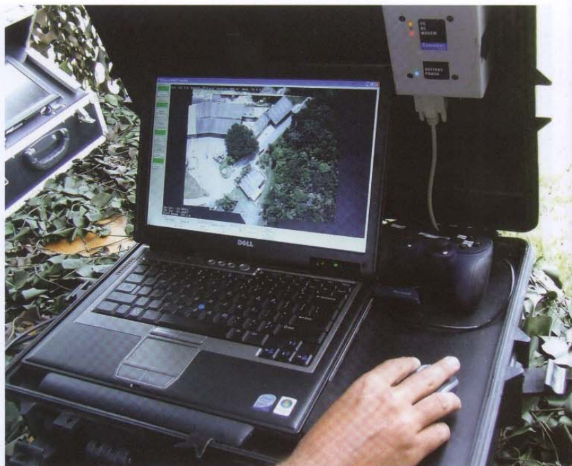
Detalhe da estação de terra, podendo ser vista na tela do notebook a imagem de uma instalação militar observada a 200 metros de altitude por um Carcará voando a 45 km/h (IAS - Indicated Air Speed). Embora não dê para perceber na foto, o operador acabava de selecionar, com o mouse, uma viatura para ser acompanhada automaticamente pela câmera de TV do VANT
